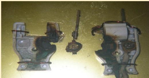
片方の差し刃が焼損
